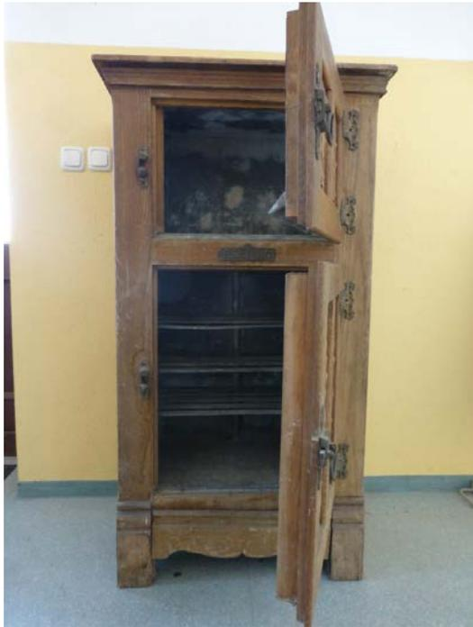
Mit Zinkblech ausgekleideter Eisschrank
